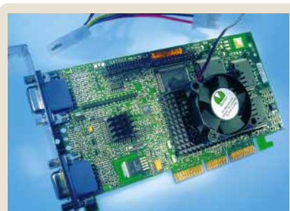
MAXymalizacja G400: wentylator od procesora 486 zamontowany na układzie G400 czyni z niego odpowiednik G400MAX.
