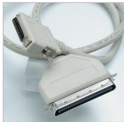
JAKOŚĆ KABLA SCSI ma duże znaczenie. Przewody powinny być skręcone parami, a całość – ekranowana.
